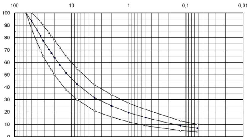
Figura 0.1 – Curva granulometrica Misto cementato 0-63.
