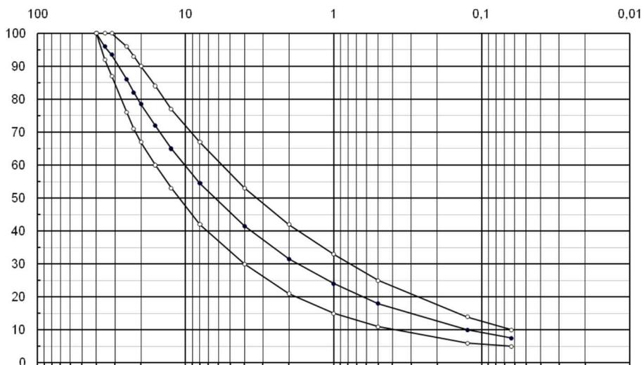
Figura 0.2 – Curva granulometrica Misto cementato 0-35.
