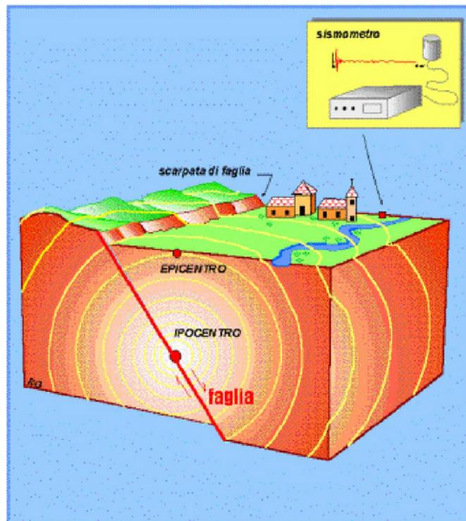
Dal punto di vista della misura strumentale del fenomeno, è fondamentale distinguere chiaramente le quantità che rappresentano la severità del terremoto alla sorgente, da quelle che misurano la violenza della scossa (moto vibratorio del suolo) in un punto a distanza dalla sorgente stessa.
