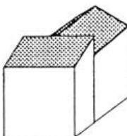
e. con falda di copertura emergente sul lato breve. Lo sfasamento va ricondotto ai tipi 4 o 5, salvo che non derivi da una originaria scelta tipologica.
