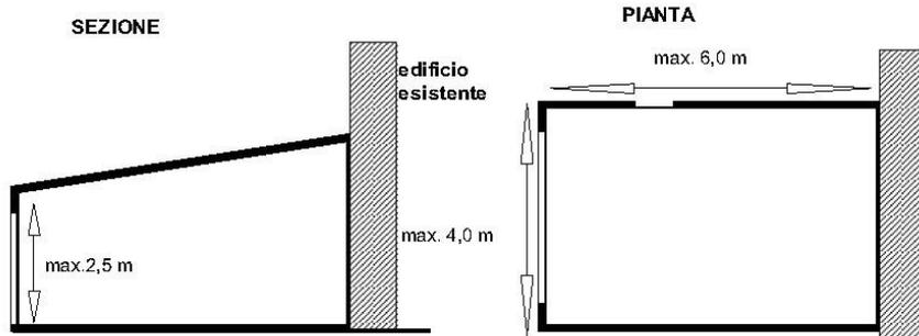
Schema compositivo delle autorimesse di tipo 2: le dimensioni ed il posizionamento delle finestre non sono vincolanti. Le misure indicate si intendono al netto delle murature.
