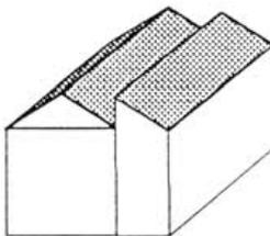
c. con copertura ad una falda emergente sul lato lungo. Il dislivello può essere recuperato riconducendo la copertura al tipo 2 o stabilendo una nuova linea di colmo sulla proiezione delle due falde contrapposte.
