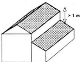
3. a capanna interrotta: come il tipo 2 ma la falda maggiore e' interrotta il dislivello tra le falde sarà maggiore a 1,0 m
