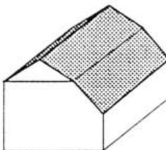
b. con falda di copertura interrotta da diversa inclinazione. La falda va ricondotta ad un'unica pendenza con recupero dell'inclinazione originaria o in analogia alla pendenza della falda contrapposta.
