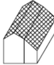
B) CON FALDA DI COPERTURA INTERROTTA DA DIVERSA INCLINAZIONE:
