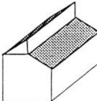
a. a falde sfalsate sul colmo. L'elemento da rimuovere è costituito dal disallineamento delle falde sul colmo di copertura.
